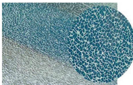
Figura 38 Detalhe de um vidro temperado quebrado (pequenos pedaços arredondados)
