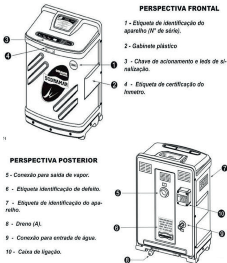
Figura 113 Gerador de vapor seus comandos e funções
