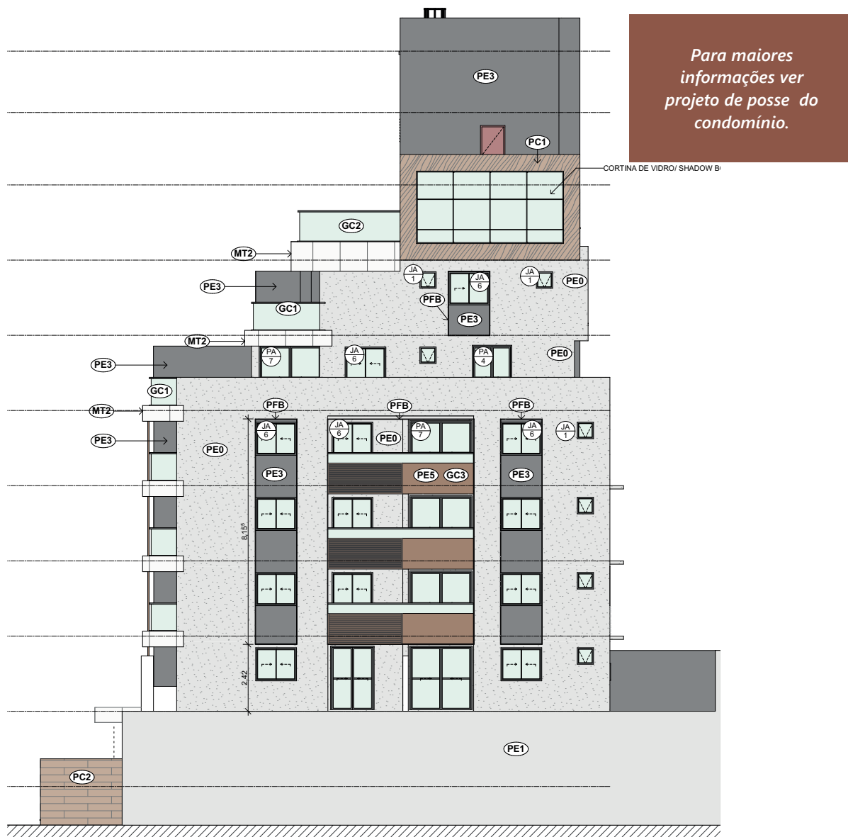
Figura 23 Fachada do Edifício Roof Top com aplicação de Textura e Revestimentos
