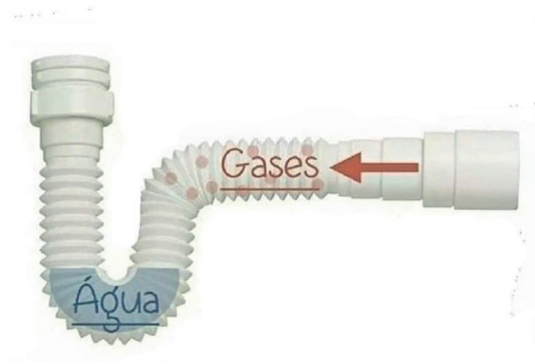
Figura 69 Representação esquemática sifão
